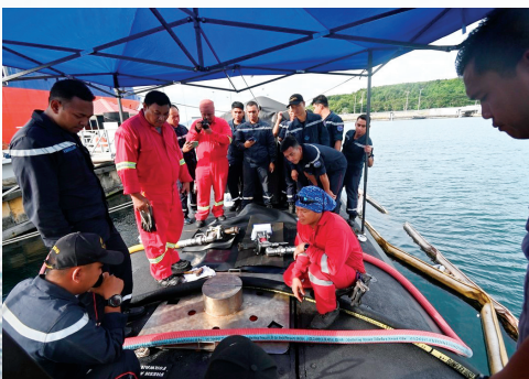
Gambar pelaksanaan pressurisation di dalam kapal menggunakan DSVDS di kompartmen hadapan
